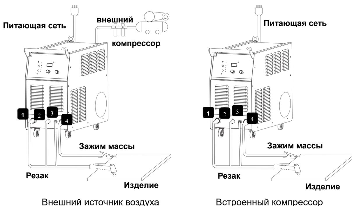
Подключение фильтра-редуктора на задней панели аппарата:
